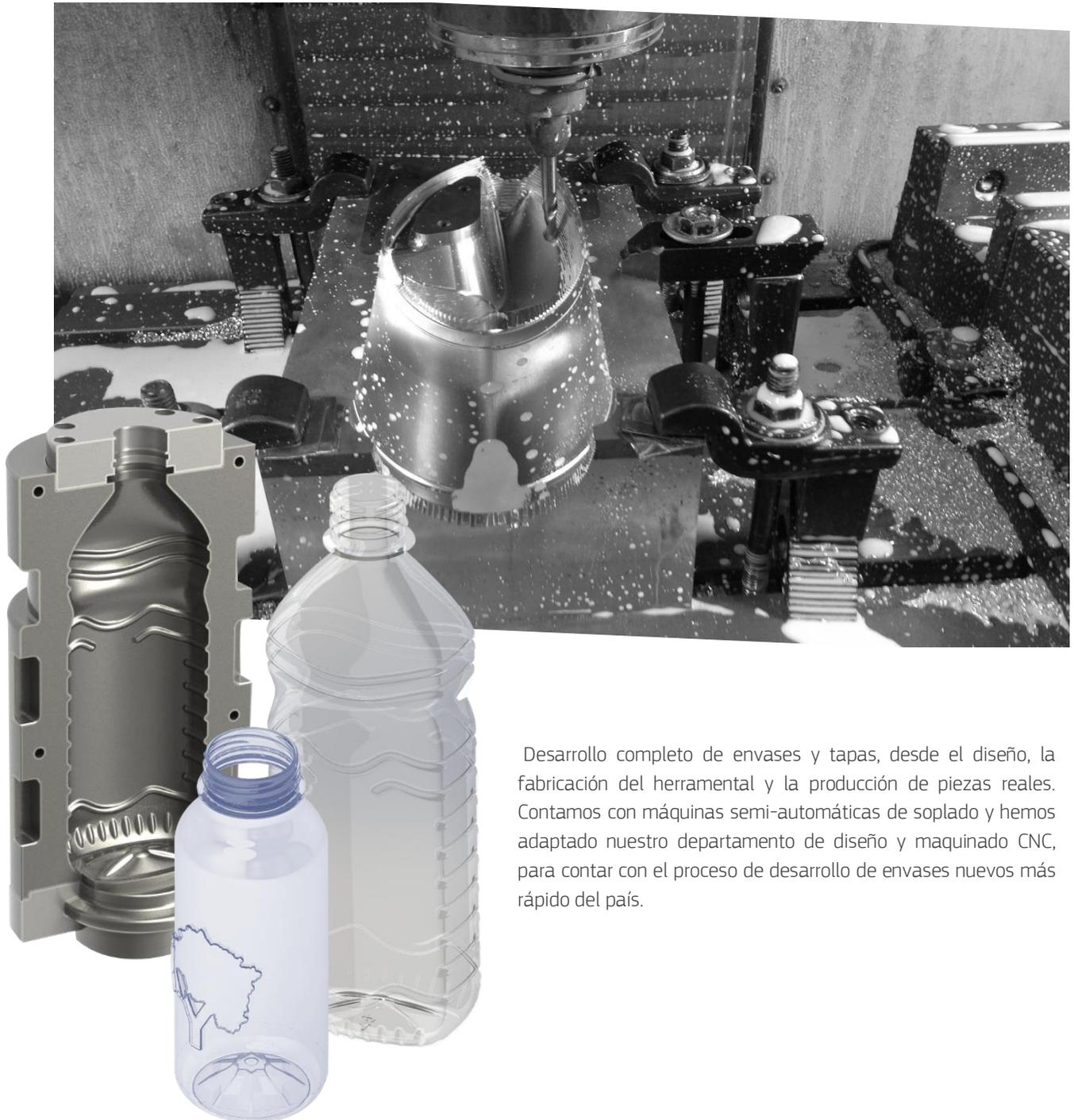
Desarrollo completo de envases y tapas, desde el diseño, la fabricación del herramental y la producción de piezas reales. Contamos con máquinas semi-automáticas de soplado y hemos adaptado nuestro departamento de diseño y maquinado CNC, para contar con el proceso de desarrollo de envases nuevos más rápido del país.
